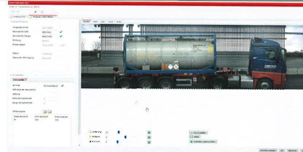
gen. Parallel dazu wird im NUMBERCHECK-System eine Datenbank vorgehalten, in welcher zusätzlich die Durchfahrtsdaten zeitlich begrenzt hinterlegt werden. Diese Datenbank kann an einem Arbeitsplatz-PC über die GUI betrachtet werden.
